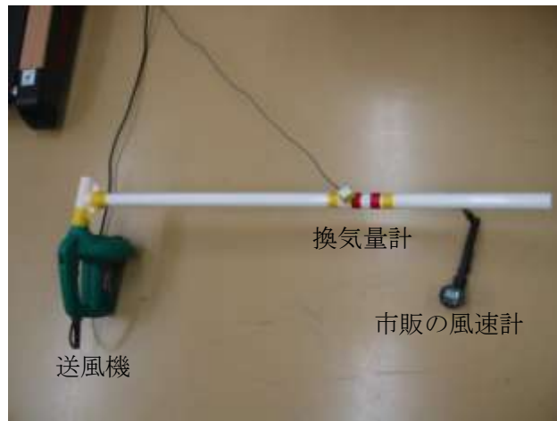
図 5.2 換気量計の校正
