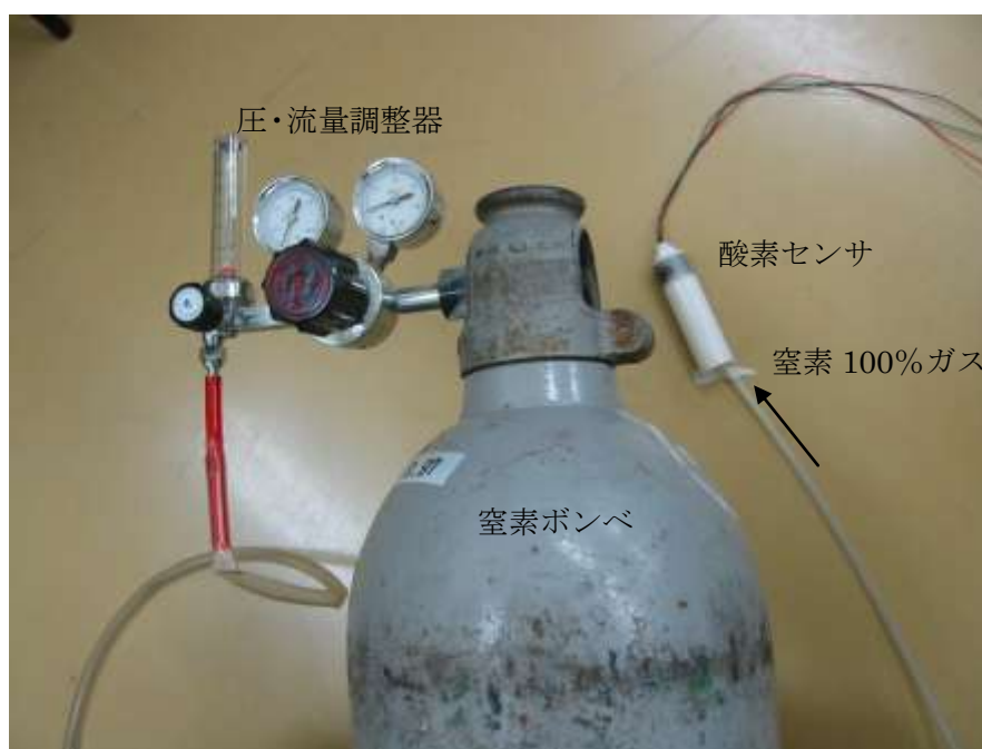
図 5.1 酸素濃度計の校正
