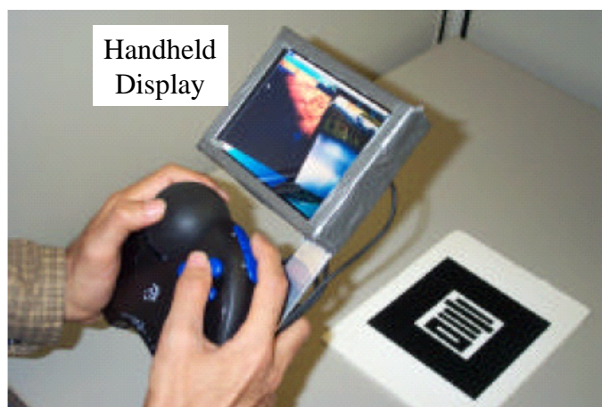
図 2.9: ビデオ型シースルーとして用いられる ARPad [10]
