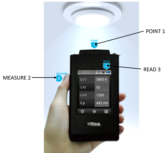
図 4.3 UPRtek MK350. POINT 1: 受光部, MEASURE 2: 測定ボタン, READ 3: モニタ [57]
