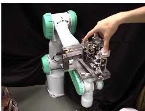
図 3.4: 遭遇型力触覚提示装置 [30]
