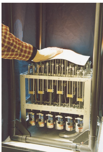
図 3.3: 対象型力触覚提示装置 [28]
