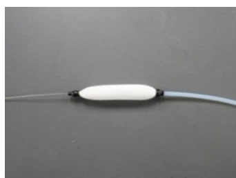
図 4.4: 空気圧アクチュエータ [36]
