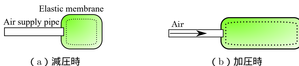
図 4.5: 空気圧アクチュエータ構造
